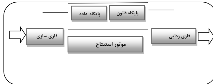
شکل ۶. شمای کلی و مراحل اصلی در یک سیستم استنتاج فازی (Roger Jang, 1933)
