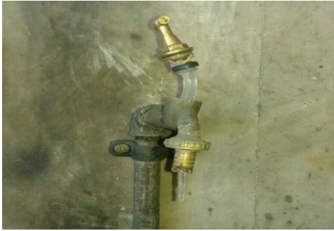
شکل ۴. سرمای شدید اردبیل و یخ بستن رودخانه بالیخی چای و ترکیدن شیر آب
